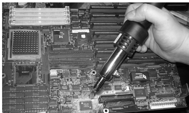
Рисунок 4: Выпаивание микросхемы феном
